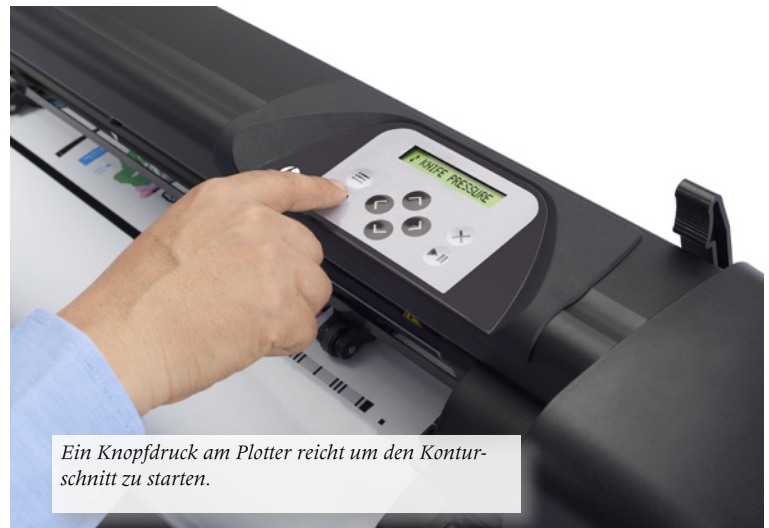
HP-eigenes Barcodesystem zur Identifizierung der passenden Konturschnittdateien
